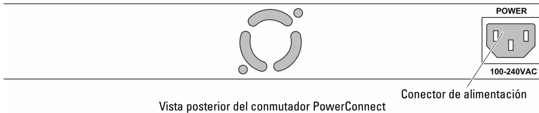
Figura 1-4. Conectores de alimentación del panel posterior
